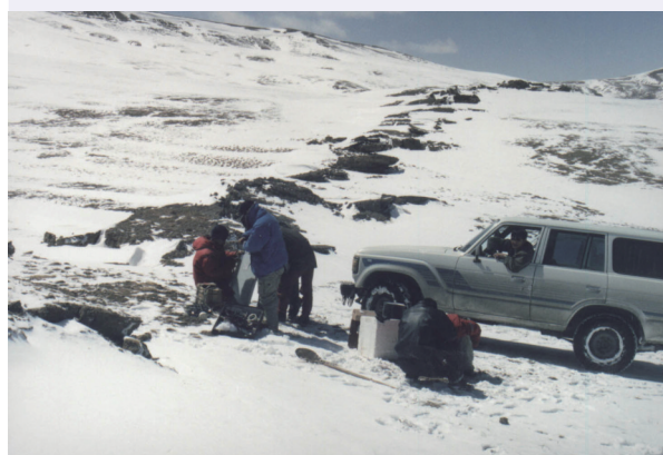
图4 2001年11月14日昆仑山口西8.1级大地震后,地震学家在地震断层带(如图中左上角线状的带所示,注意它并不是像教科书上画的那样是一条简单的直线)上通过观测断层带的“围陷波”来研究断层的“愈合”过程
