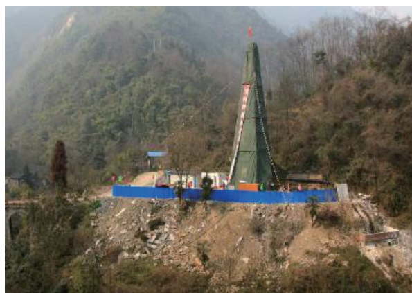
图3 2008年5月12日汶川8.0级大地震后,科学家在地震断层带上实施科学钻探,通过在断层带上采集岩心和随钻进行的各项物理测量,理解地震发生时在断层上究竟发生了什么。如图是在龙门山断裂带中北段实施的汶川科钻三号孔的现场作业情况
