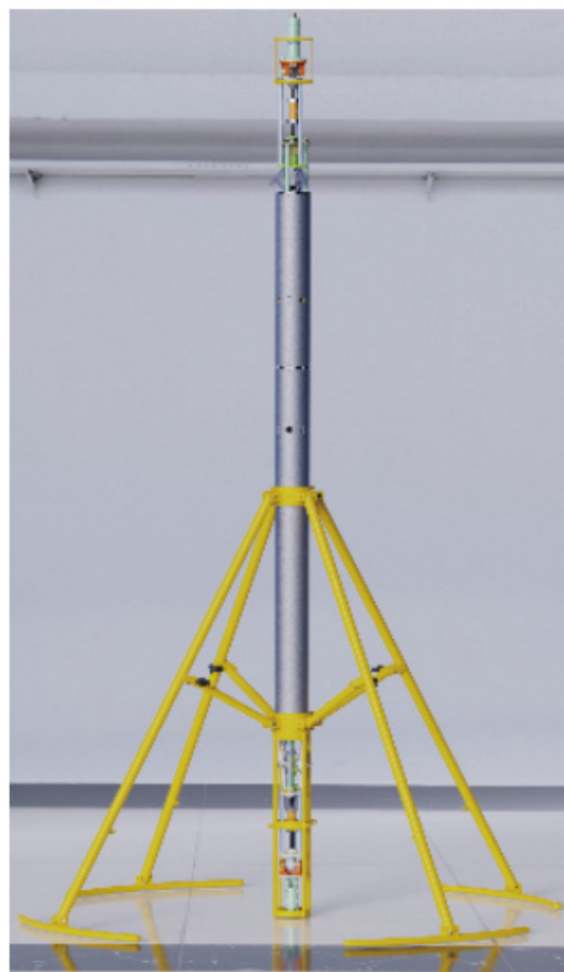
深井综合观测井下设备
