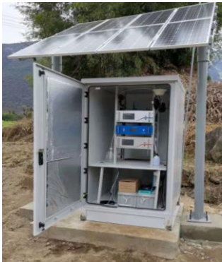
高精度氢新型传感器野外观测实验
